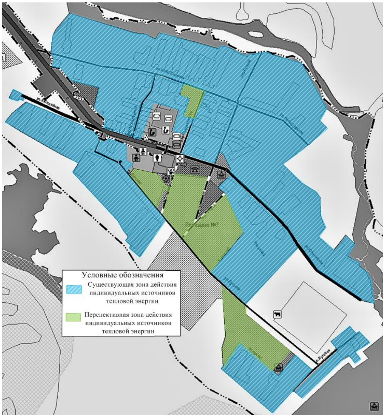
Рис. № 18 – Существующие и перспективные зоны действия индивидуального теплоснабжения на территории села Боровка
